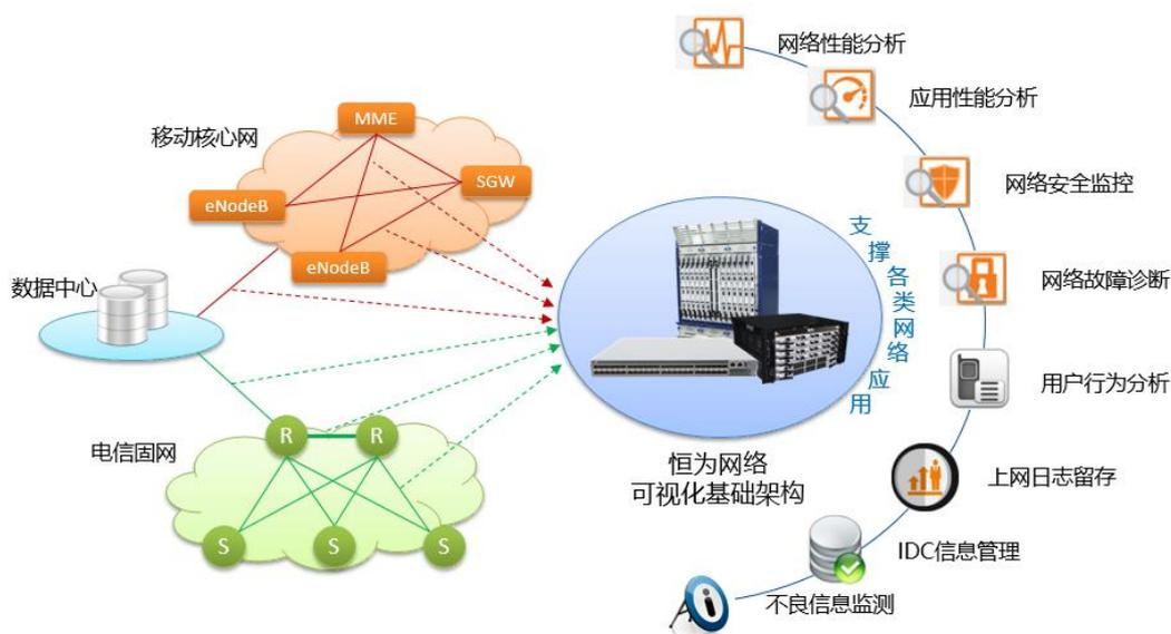
由上图可见，公司的网络可视化基础架构产品，主要部署在移动核心网、宽带骨干网、IDC出口等位置，对采集到的大规模网络流量的原始数据进行各类加工处理，为下游各类网络可视化应用，包括网络优化与运维、信息安全、大数据运营等，提供精炼的、满足特定应用需求、并且易于使用和处理的的数据和信息。
